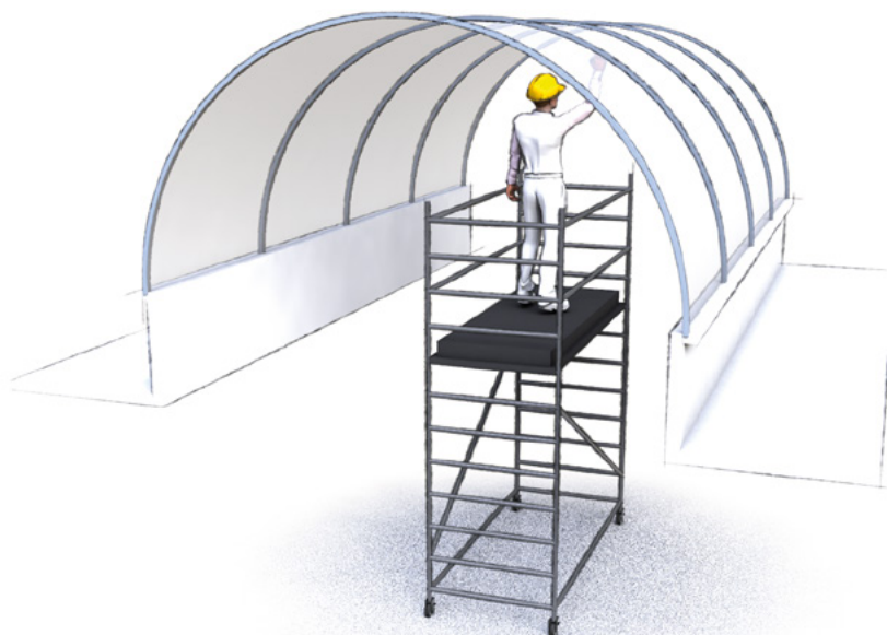
■ Figure 7.5 – Exemple de schéma d'implantation pour le nettoyage des sous-faces des parties vitrées.
