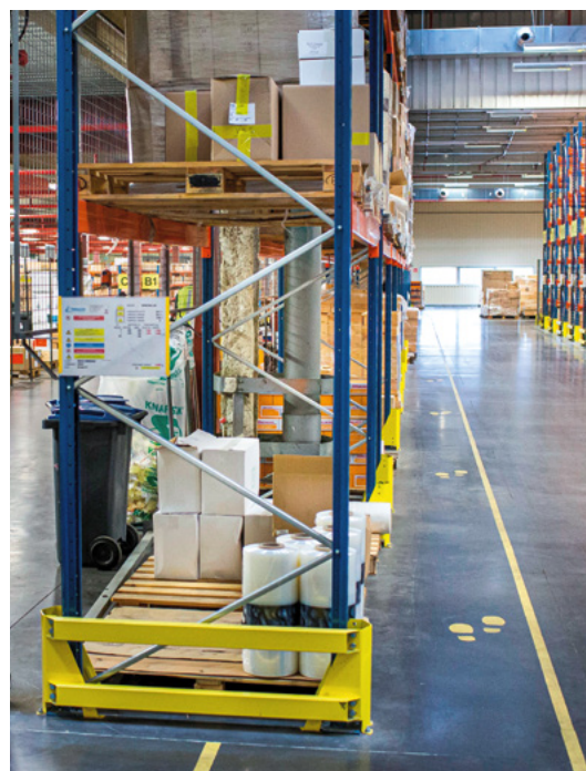
Photo 8.1 – Exemple de racks aménagés sur le plan de la sécurité : plancher de positionnement et butées de pied d'échelle.
