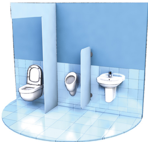
■ Figure 10.1 – Équipements suspendus facilitant le nettoyage.
