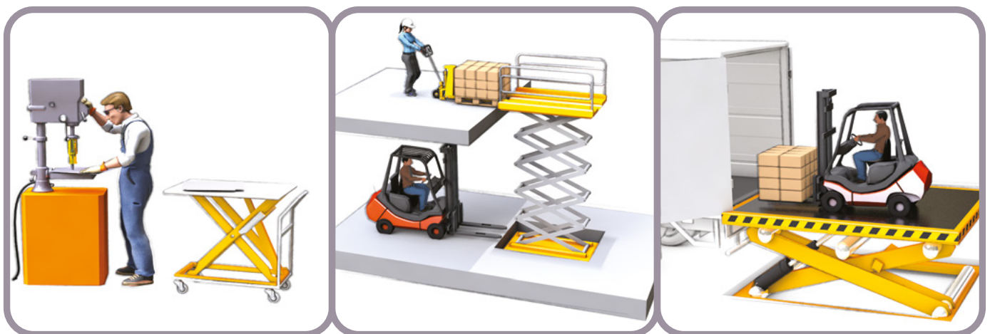
■ Figure 8.13 – Exemples d'utilisation de tables élévatrices.
