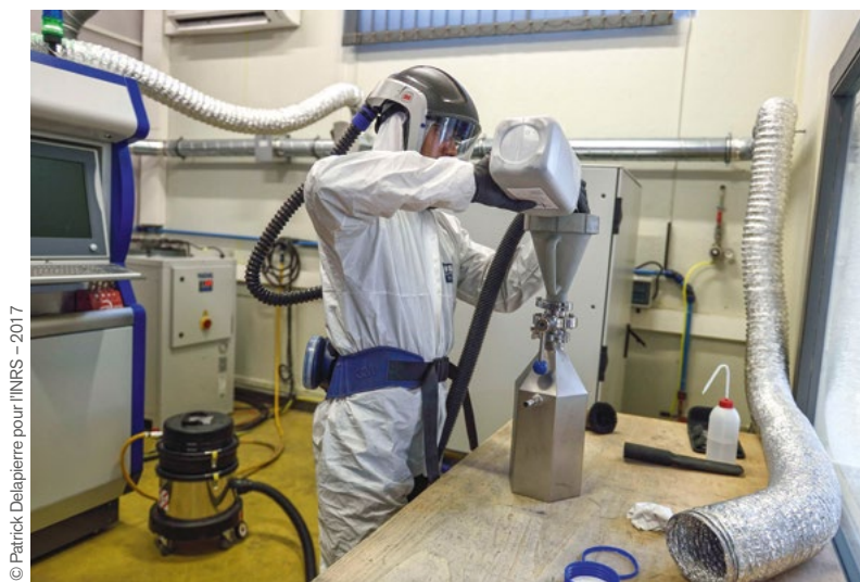
■ Figure 18. Port de vêtement de protection contre les risques électrostatiques, gants et casque à ventilation assistée par un opérateur travaillant en zone ATEX
