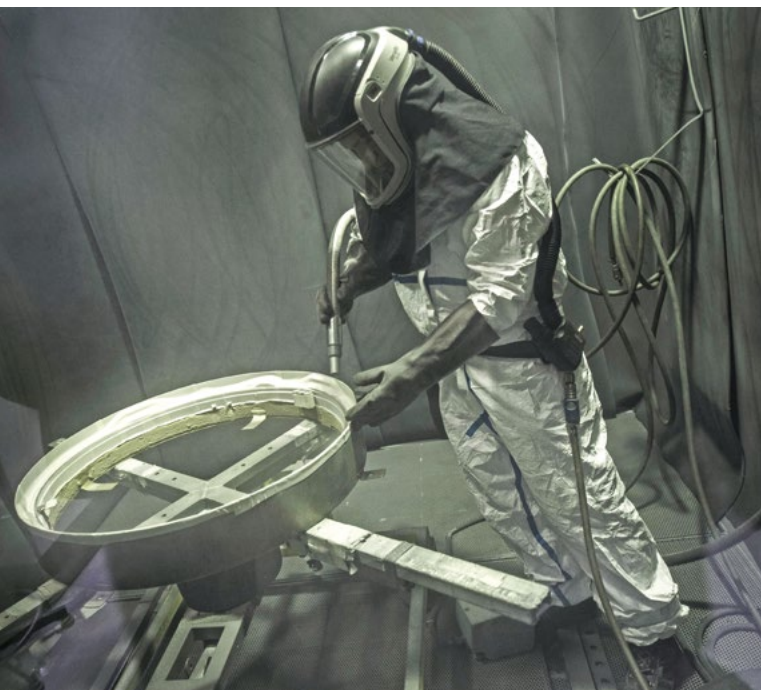
■ Figure 11. Opérateur équipé de vêtement de protection contre les projections d'abrasifs en grains, gants et cagoule à adduction d'air lors d'opération de sablage
