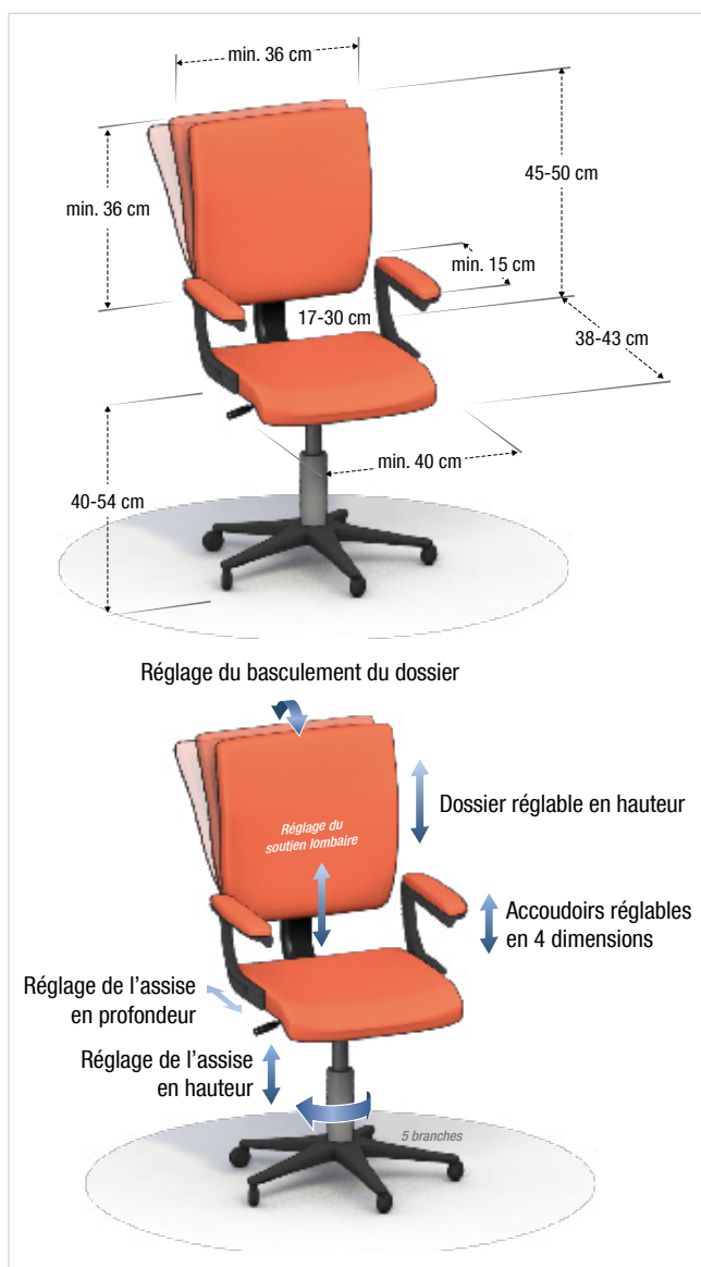
■ Figure 3. Principales dimensions et réglages d'un siège de bureau.
