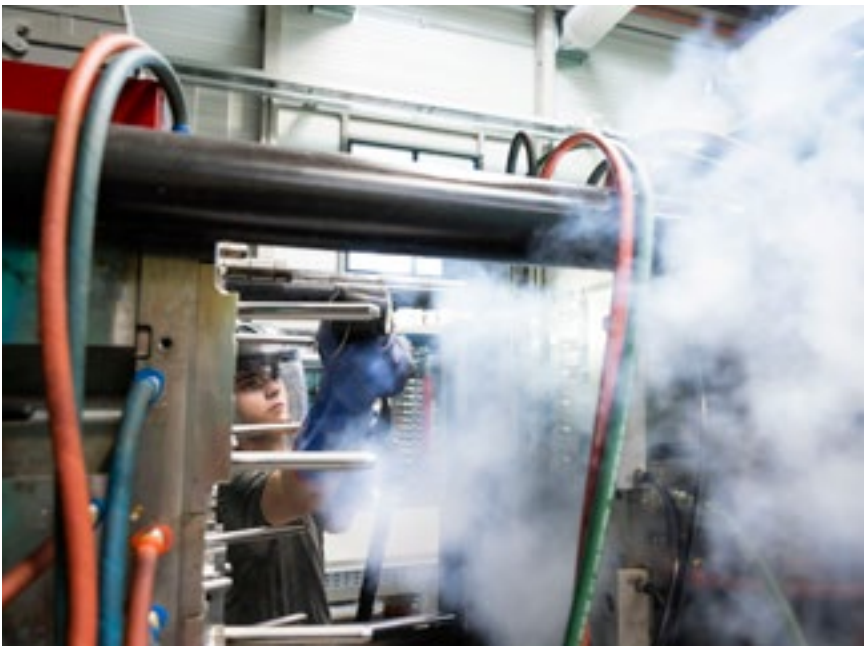
Photo 1 – Nettoyage cryogénique à la carboglace de moules en plasturgie
