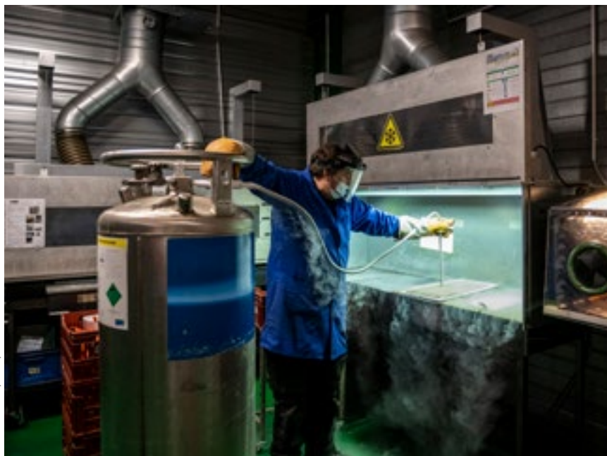
■ Photo 2 – Récupération de rebus d'outils par trempe à l'azote liquide
